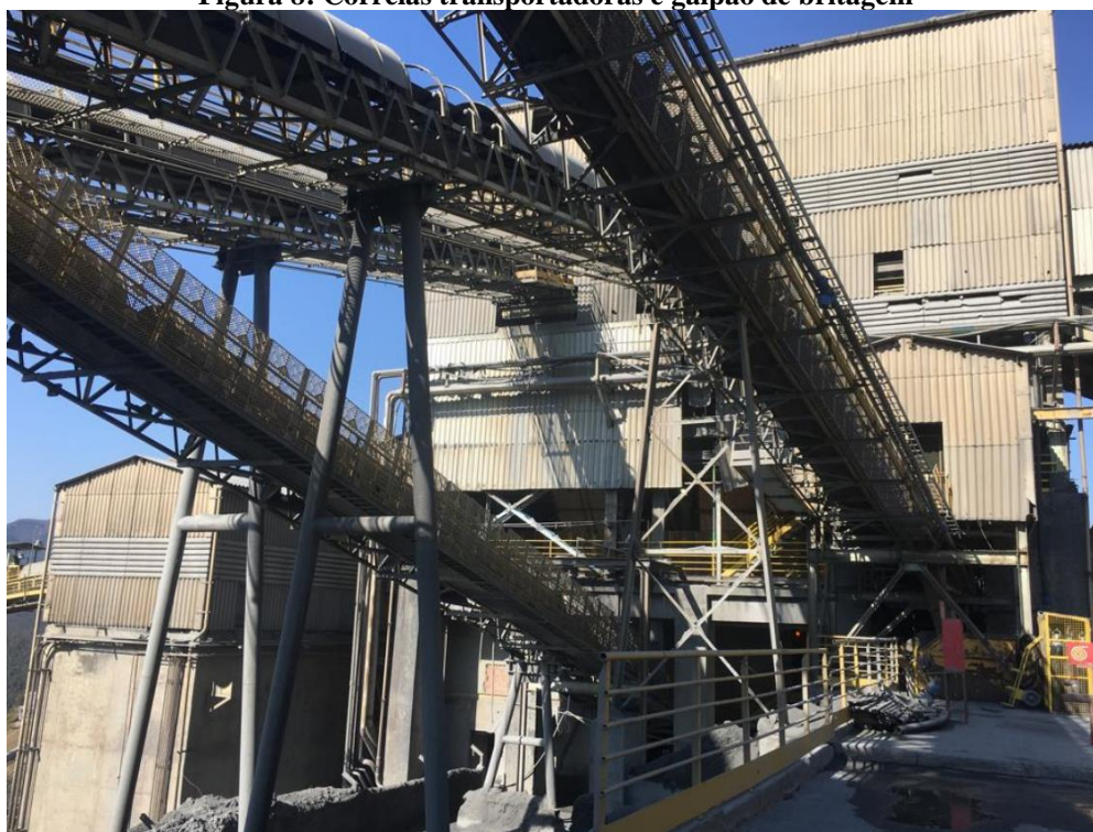
Figura 8: Correias transportadoras e galpão de britagem
